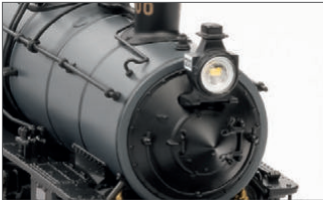
Neben dem Zweilicht-Spitzensignal ist das Notlicht an der Rauchkammer-tür separat digital schaltbar.
