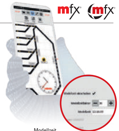
Modellzeit kann als Element auf Stellpult oder Platte hinzugefügt werden. Der Modellzeitfaktor lässt sich in den Einstellungen einstellen.
