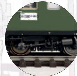
Vorbildgerecht mit Drehgestellen Minden- Deutz (MD) schwer Bauart 330 mit Kardanachsgenerator Bauart D 150
